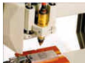
Figura nr. 72 Gravimi me metodën elektro për çelikun legurë dhe veglat
